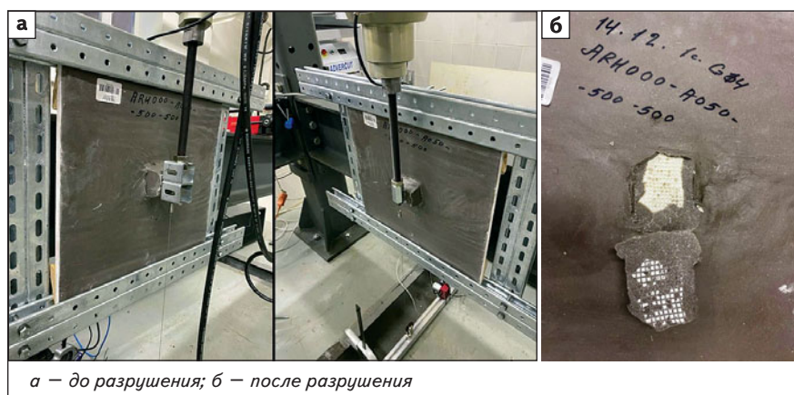
Рис. 2. Образец для испытания на срез
