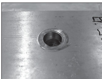
Рис. 4. След от вмятия шайбы в алюминий при моменте затяжки 100 Н·м
