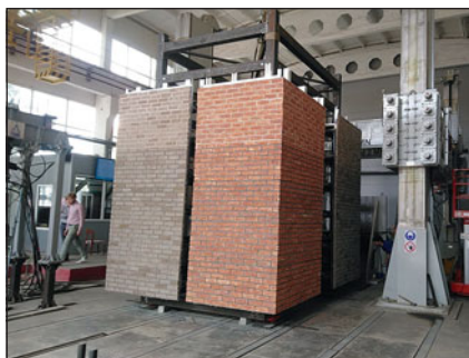
Рис. 4. Стенд с закрепленной НФС «U-коп» типа АТС-450
