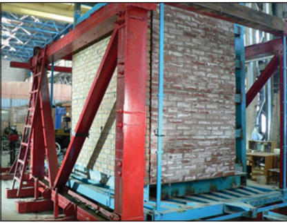
Рис. 1. Стенд с закрепленной на нем НФС «Метроспецстрой-Д21 кп»
