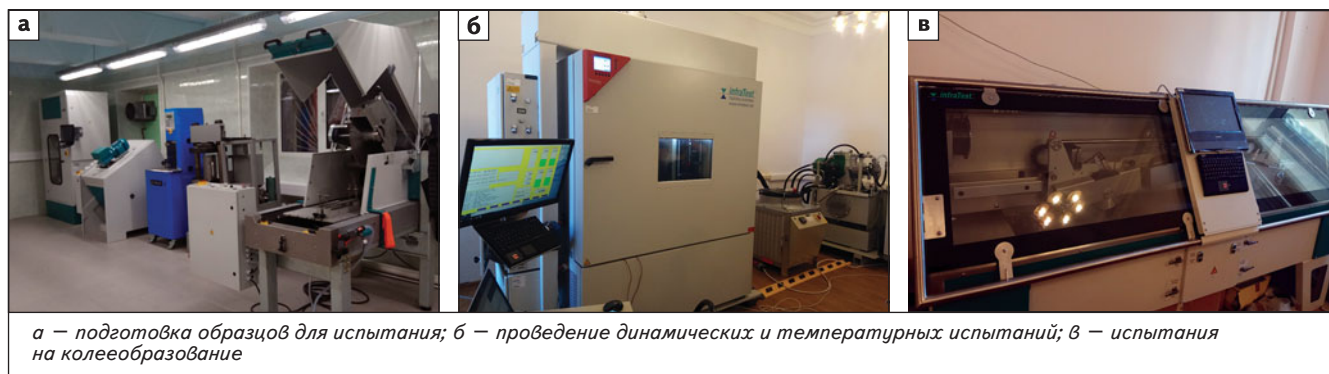
Рис. 1. Испытательное оборудование лаборатории ЦКП МАДИ
