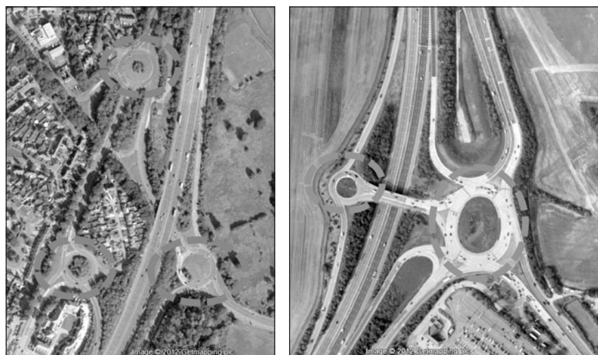
Рис. 2. Кольцевые пересечения в зоне неполных транспортных развязок (Великобритания)
