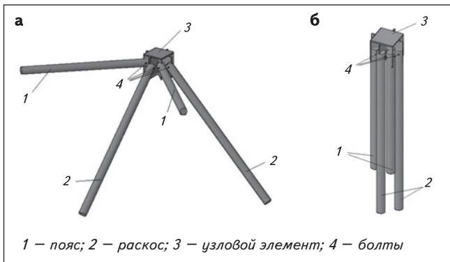
Рис. 1. Принципиальная схема трансформирующейся отправочной марки в проектном (а) и транспортировочном (б) положениях
